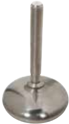
Part. R0749 - Pag. R38 Ø 120 • Stainless steel • Hygiene • Max. load 25000 N.
